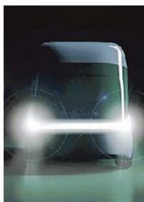
LightBus è una sorta di mattoncino Lego a velocità costante che può trasportare fino a 27 persone a bordo (ma si possono configurare anche a 18 o 22 posti, magari per le aziende di noleggio senza conducente); è lungo 8,6 metri e largo 2,3 metri. Il suo essere un veicolo modulare è molto utile in caso di riparazioni: si cambia il pezzo rotto e lo si sostituisce. Si configura come un mezzo di trasporto collettivo molto all'avanguardia.
