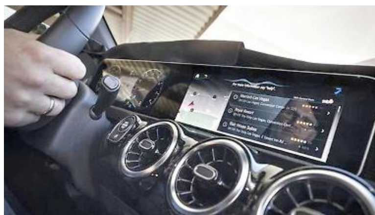
Cruscotto digitale con la capacità di elaborare i dati sul traffico e comunicarli al guidatore
